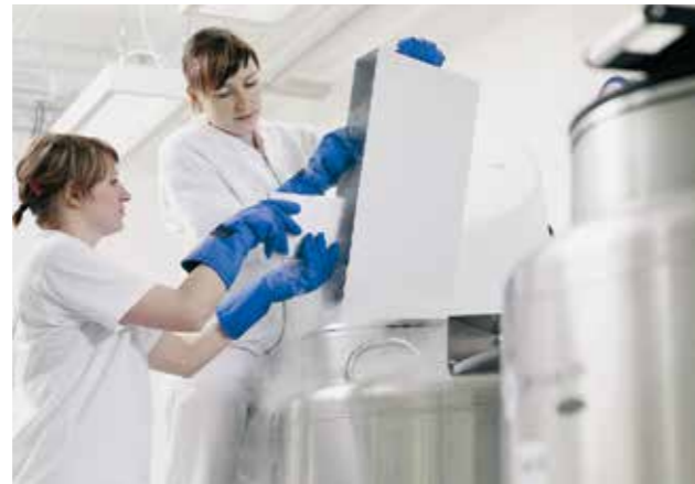
Knapp zwei Tonnen Gewicht, doppelwandig mit einer dazwischen liegenden Vakuumschicht isoliert, stromunabhängig: Die Tanks von Vita 34 sind sicher und hundertprozentig geschützt.
